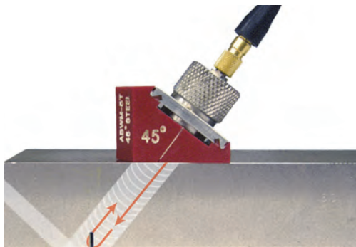
图 5-9 常规角度声束检测
