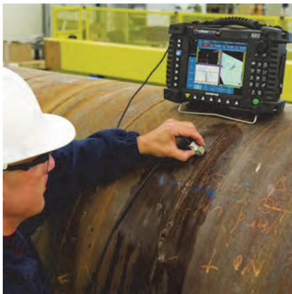
图 5-1 使用 OmniScan 进行典型的相控阵检测
