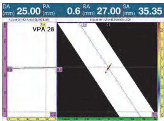
图 5-17 底面边角位置的反射体
