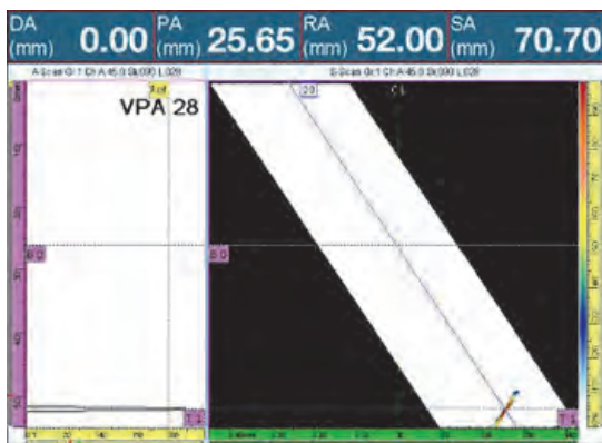
图 5-18 上面边角位置的反射体
