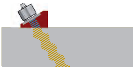
图 2-13 入射角度为 30°，超出这个第一临界角度，纵波将不再存在，所有折射能量都被包含在横波中
